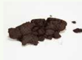
En essayant de former un cylindre, l'échantillon s'est désagrégé.
