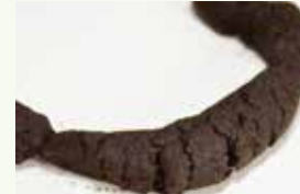
En pliant le cylindre, la terre s'est fissurée et même brisée entièrement.
