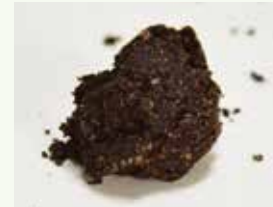
La boule s'est désagrégée en essayant de la rouler entre vos mains.
