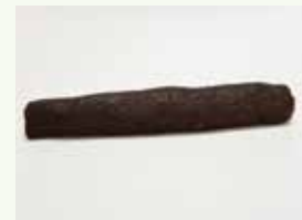
Il a été possible de former un cylindre de 6 à 7 cm.
