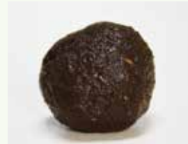
La boule est restée intacte après avoir été roulée entre vos mains.
