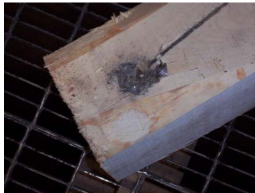
f. Présence de corps étrangers Non acceptable
