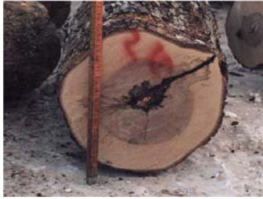
h. Fente ou gélivure Acceptable sciage
